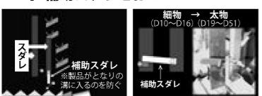
冷却床の溝に落するためのスダレの下部へ設置してある可動式スダレを「補助スダレ」という。
