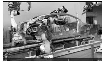
プリウスをロボット溶接している作業の再現
